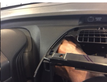
5. Monter Wifi antennen inderst i venstre og højre side af radiatorummet
