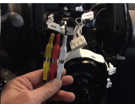
3. Vip klimapanellet ud - det skal ikke afmonteres helt - således dy kan få fat i stik på cigartænder
