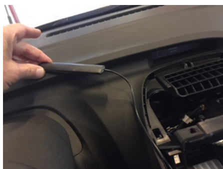
5. Monter Wifi antennen inderst i venstre og højre side af radiatorummet
