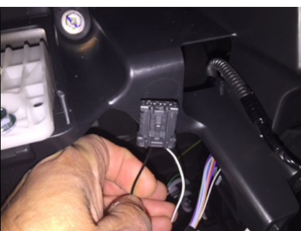
3. Vip klimapanellet ud - det skal ikke afmonteres helt - således dy kan få fat i stik på cigartænder
