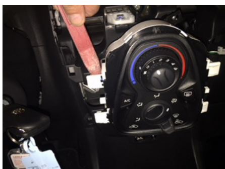
3. Vip klimapanellet ud - det skal ikke afmonteres helt - således dy kan få fat i stik på cigartænder
