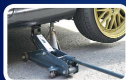
Heben Sie das Fahrzeug an, bis das Rad vom Boden abhebt. Legen Sie einen Unterstellbock unter das Fahrzeug.
