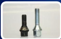
**BEACHT:** Länge der NEUEN Radbolzen muss der Länge der bisherigen Radbolzen plus der Breite der Spurplatte entsprechen.
