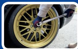
Ziehen Sie die Radbolzen kreuzweise in mindestens zwei Durchgängen an.
