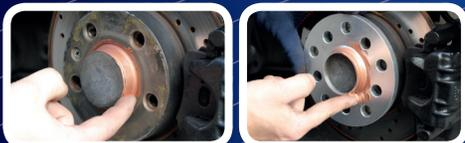
Stecken Sie die Distanzscheibe auf die Achse und schmieren Sie diese dünn mit Kupfer-/Keramikpaste ein.
