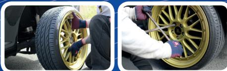
Legen Sie das Rad an und befestigen Sie es mit den NEUEN Radbolzen. Ziehen Sie die Radbolzen handfest (max. 25Nm) an. Prüfen Sie die Mindestumdrehungen der Radbolzen (siehe Tabelle)!
