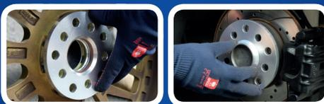
Prüfen Sie, ob die Spurplatte vollflächig an der Nabenanlagefläche der Felge anliegt und ebenso vollflächig an der Radanlagefläche der Achse anliegt.
