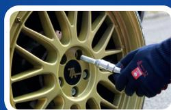
Entfernen Sie die Radbolzen.
