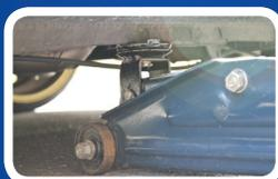
Setzen Sie den Wagenheber an der dafür vorgesehenen Stelle an, sodass Ihr Rad leicht entlastet ist.
