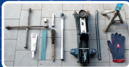
Arbeiten Sie nur mit geeignetem Werkzeug (Wagenheber, Drahtbürste, Drehmomentschlüssel, Kupferpaste).
